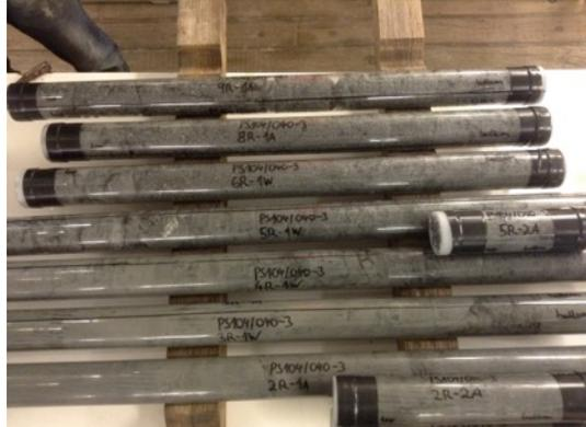
MeBo-Bohrkerne mit verschiedenen Lagen konsolidierten Sediments. Die in den Plastikrohren befindlichen Kerne werden erst später in zwei Hälften geteilt, um die Sedimente zu beproben Foto: Alfred-Wegener-Institut / Karsten Gohl
