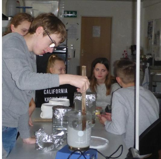
Abbildung 4 SuS bereiten die Salzlösung für die Dichte Separation vor
