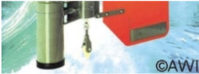
Elektromechanischer Strömungsmesser (Aanderaa.Instruments)
