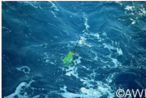
Driftkörper, der in 750 m Wassertiefe treibt und in regelmäßigen Zeitabständen an der Meeresoberfläche auftaucht, um geortet werden zu können
