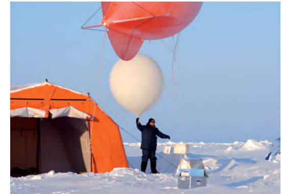
▲ Expedition in der Arktis: Start einer Ozonsonde auf der Eisscholle NP-35, im Vordergrund ein roter Fesselballon. (Foto: J. Graeser)
