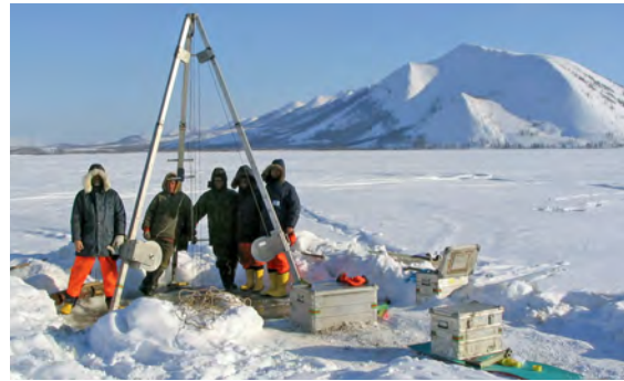
▲ Der zugefrorene Billjach-See im winterlichen Werchajansker Gebirge Ostsibiriens. Das Dreibein wird zur Kernung und Beprobung von Seeschlämmen genutzt (Foto: B. Diekmann)
