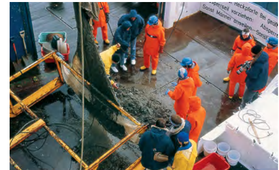
▲ Grundschieppnetz auf dem Arbeitsdeck (Foto: AWI)
