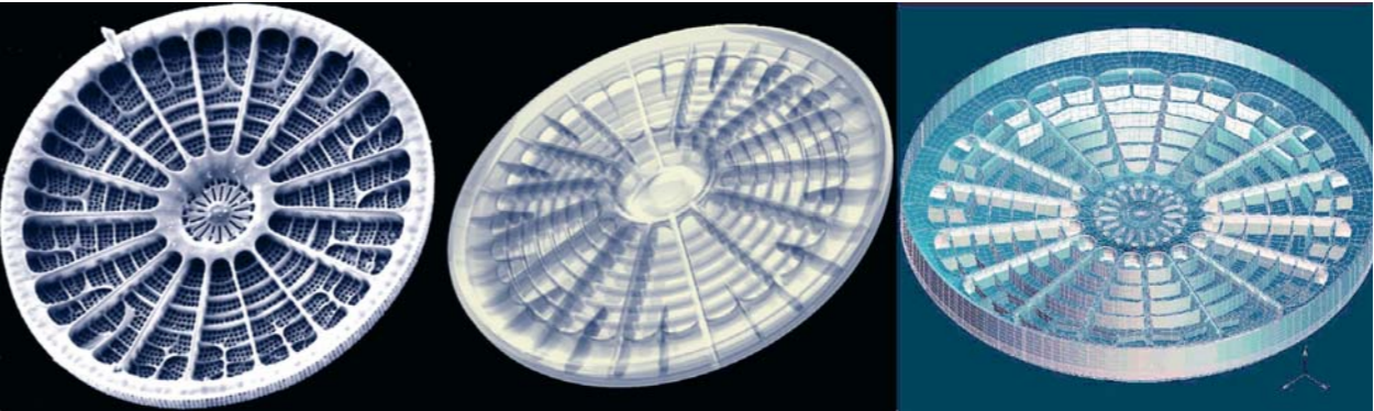
Abb. 1: Elektronenmikroskopische Aufnahme, CAD- und FE-Modell einer Autofelgenfront abgeleitet von der Diatomeenart Arachnoidiscus .
