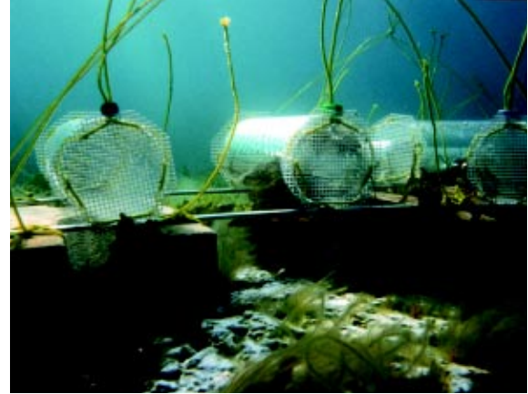
Abb.7: UV-Ausschluss-Experimente, in denen mit Hilfe von Glasfiltern oder Kunststofffolien bestimmte Wellenlängenbereiche ausgeschlossen werden können. Entweder wurde die gesamte UV-Strahlung (UVA + UVB) ausgeschlossen und die Organismen wurden nur mit Wellenlängen oberhalb von 400 nm bestrahlt, oder es wurde nur die UVB-Strahlung unterhalb von 320 nm ausgeschlossen. Die Ergebnisse wurden mit der Reaktion der Organismen im vollen Sonnenlicht verglichen.
