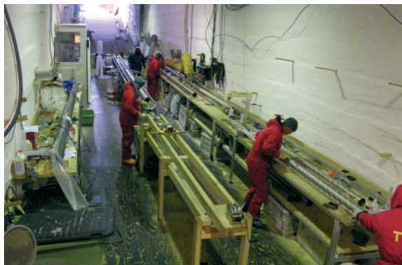
Abb. 2: Blick in die Halle aus Schnee und Eis, in der die Bohrarbeiten ablaufen. Rechts im Vordergrund ist ein Kernrohr zu sehen, in dessen Innerem die einzelnen Eiskerne nach oben kommen.
